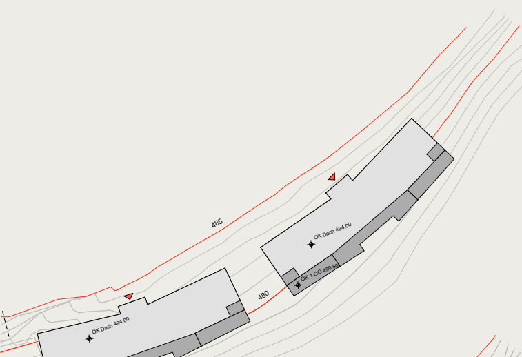
symetrischer Gebäudeknick orientiert an der Topographie, Rotationsversatz zwischen den Baukörpern
