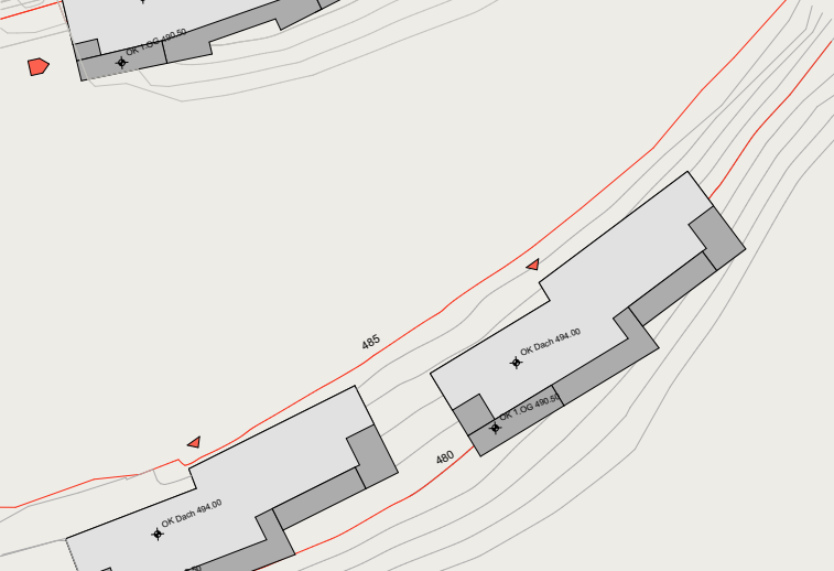
asymetrischer Gebäudeknick, Versatz zwischen den Baukörpern in zwei Richtungen
